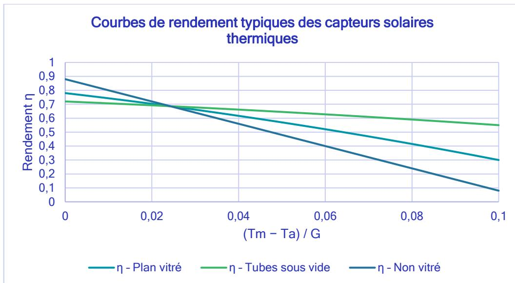
*Courbes de rendement typiques de capteurs solaires thermiques (cas belge).*
